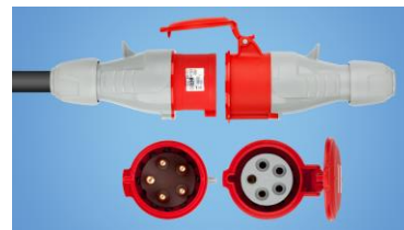
IEC 60309-P&C / AC220/380V - 30A 3P+N+E
