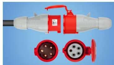
IEC 60309-P&C / AC220/380V - 30A 3P+N+E
