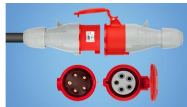
IEC 60309-P&C / AC220/380V - 30A 3P+N+E
