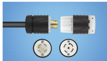
NEMA L21-30 P&C / AC100/200V -30A 3P+N+E
